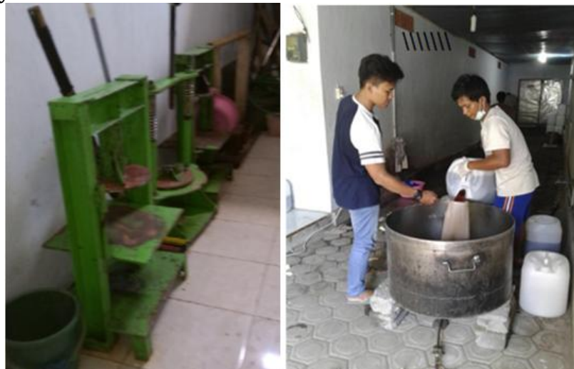
Gambar 4 Alat Press Limbah Mengkudu Fermentasi dan Proses Pasteurisasi
