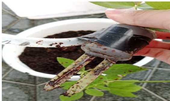
Gambar 4. Korosi pada sensor tipe resistif
