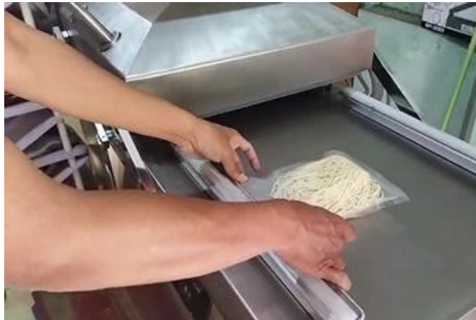
Gambar 3. Proses peletakan mie di Chamber 1
