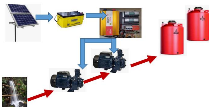
Gambar 2. Implementasi Sistem Pompa Air dengan Sumber Sel Surya
