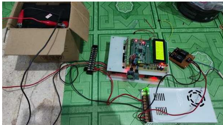
Gambar 4. Proses Charging Baterai Menggunakan Zeta Converter
