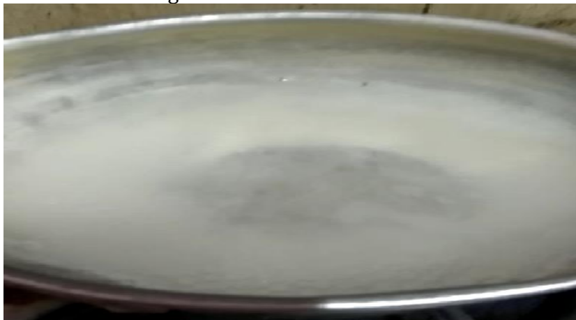
Gambar 1. Panci yang berkerak karena air mengandung kapur
