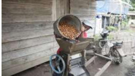
Gambar 2. Proses Pelepasan Biji Kopi Dari Kulit
