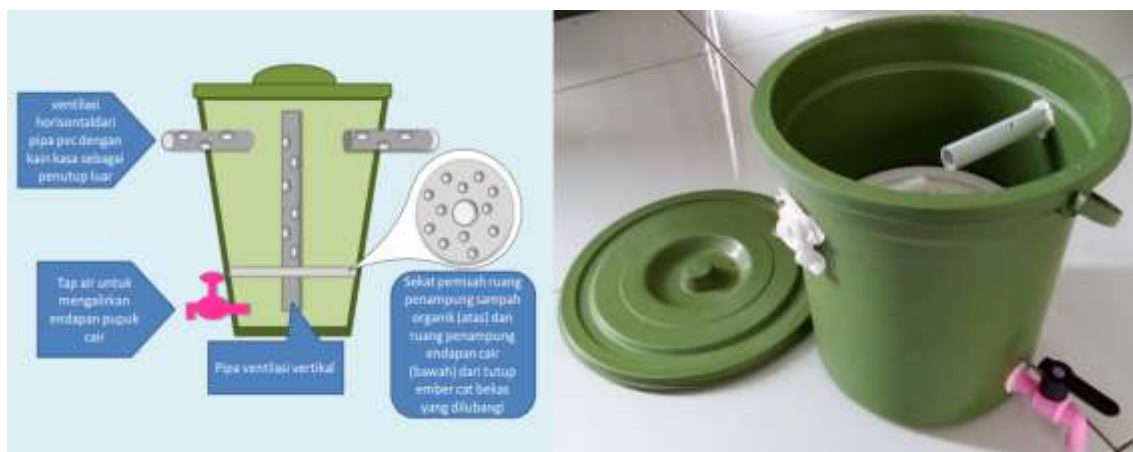
Gambar 1. Gambar desain (kanan) dan foto compost bin yang sudah dirakit (kiri)
