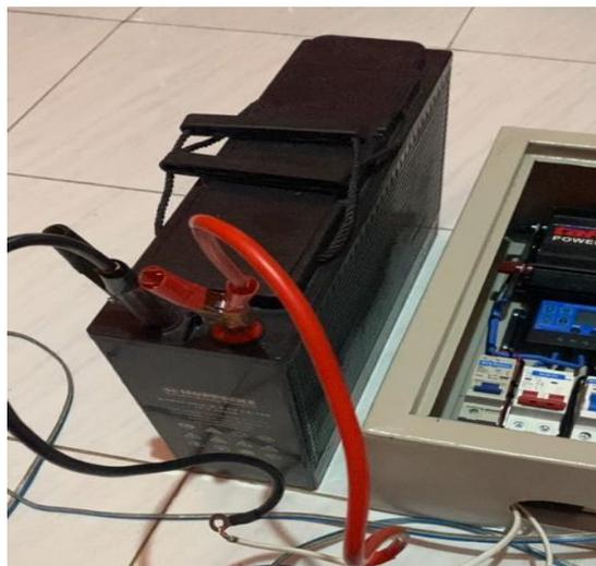
**Gambar 3. Aki 12 Volt dengan kapasitas 35 Ah.**
