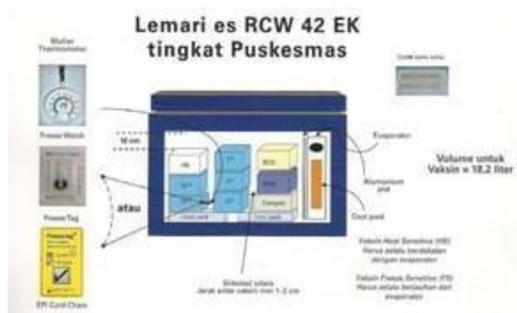
Gambar 5 Contoh penyimpanan vaksin dalam lemari es bentuk pintu buka atas
