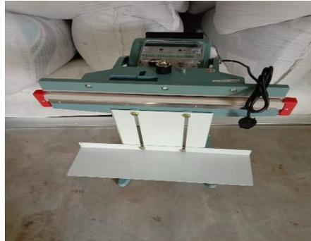
Gambar 5. Alat Sealer Penutup Karung Benih
