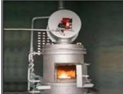
Gambar 3. Gambar *Incinerator* Limbah Padat
