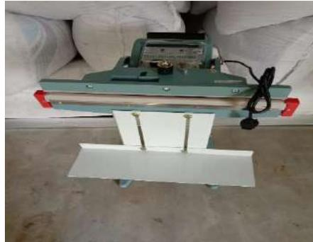
Gambar 5. Alat Sealer Penutup Karung Benih
