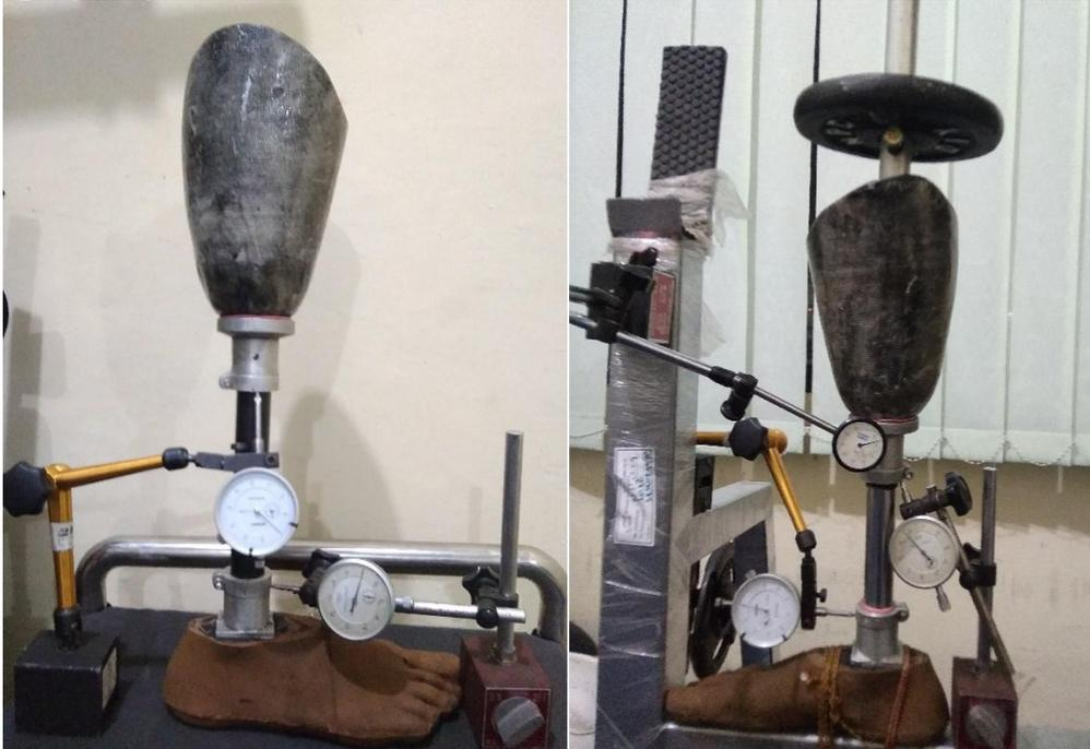
Gambar 3.3. Pengujian Prototype Lower Limb Prosthesis, (kiri: posisi pembacaan alat ukur, kanan: posisi pembebanan dengan 5Kg beban)
