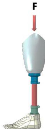
Gambar 2.2. Skema pembebanan pada prototipe
