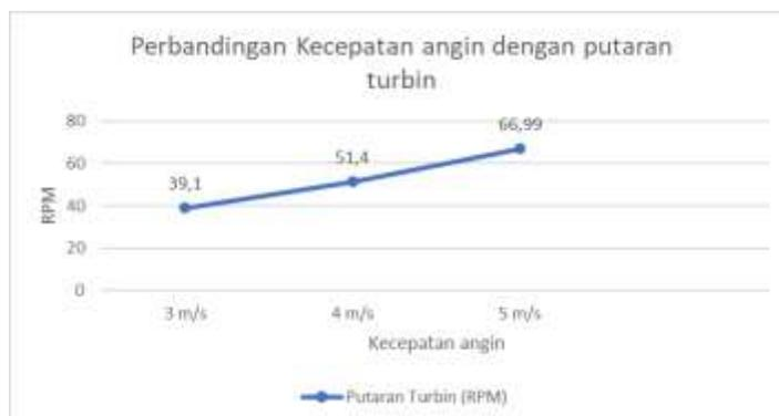
**Gambar 10. Perbandingan kecepatan angin dengan putaran turbin dengan deflektor dan diffusor**
