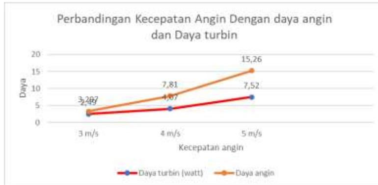
**Gambar 9. Perbandingan kecepatan angin dengan daya turbin dan daya angin dengan deflektor**
