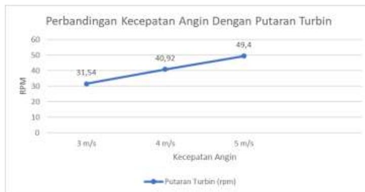
**Gambar 8. Perbandingan kecepatan angin dengan putaran turbin dengan deflektor**
