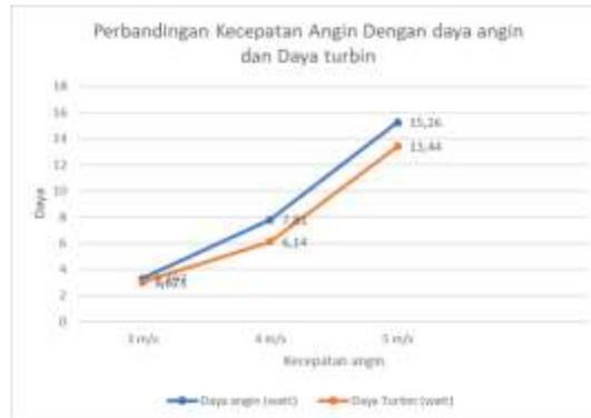
**Gambar 11. Perbandingan kecepatan angin dengan daya turbin dan daya angin dengan deflektor dan difusor**
