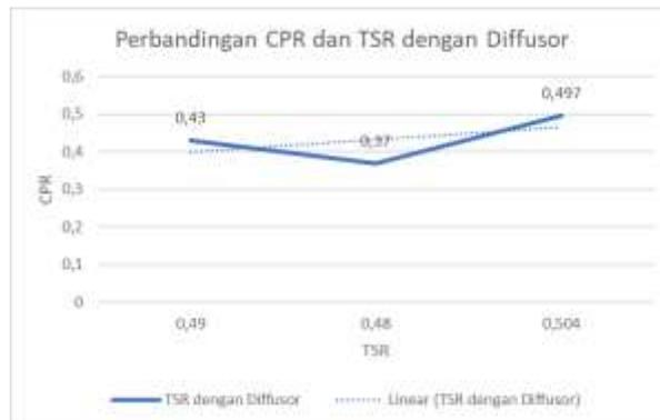
**Gambar 13. Perbandingan TSR dan CPR dengan diffusor**
