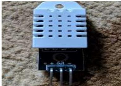
Gambar 2. Sensor DHT 22
